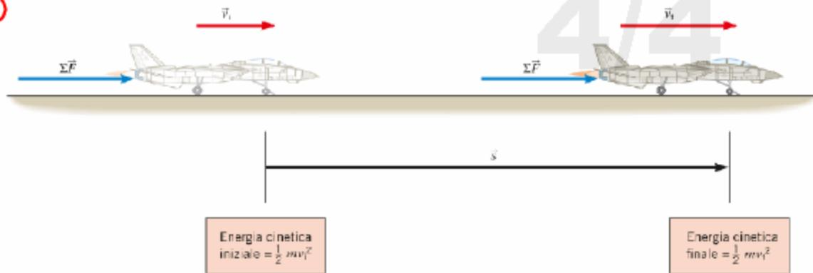
Di conseguenza la velocità dell'aereo cambia dal valore iniziale  $v_i$  al valore finale  $v_f$ . Moltiplicando entrambi i membri dell'equazione per lo spostamento  $s$  si ottiene:
